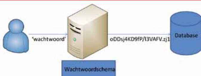
Fig. 1. Authenticatie via een wachtwoordschema. De gebruiker voert zijn wachtwoord in en het systeem genereert daar een wachtwoordhash van.
