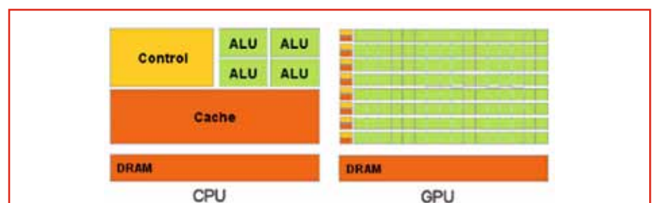
Fig. 2. Verschil in architectuur tussen grafische kaart (GPU) en normale processor (CPU). De groene ALU's zijn de rekeneenheden, ook wel cores genoemd. (Bron:[1])
